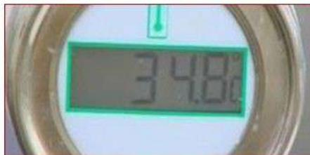
**02.** Il latte, posto all'interno delle caldaie d'acciaio, viene progressivamente riscaldato raggiungendo una temperatura può variare tra i 33°C e i 39°C.
