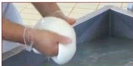
**07.** Tramite la 'formatura' (effettuata a mano o a macchina), si dà la forma alla pasta. La 'mozzatura' avviene quando la pasta, soggetta a trazione, viene 'mozzata' (ovvero tranciata).
